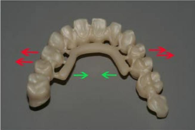
Der Sintersteg sollte hier immer um eine Zahnbreite länger sein als der Bogen des Gerüsts.
