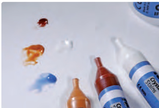
IPS e.max CAD Crystall./Shades und Stains der Spritze entnehmen und durchmischen. Bei Bedarf mit IPS e.max CAD Crystall./Glaze Liquid verdünnen
