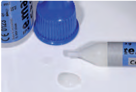
IPS e.max CAD Crystall./Glaze Paste der Spritze entnehmen und durchmischen. Bei Bedarf leicht mit IPS e.max CAD Crystall./Glaze Liquid verdünnen
